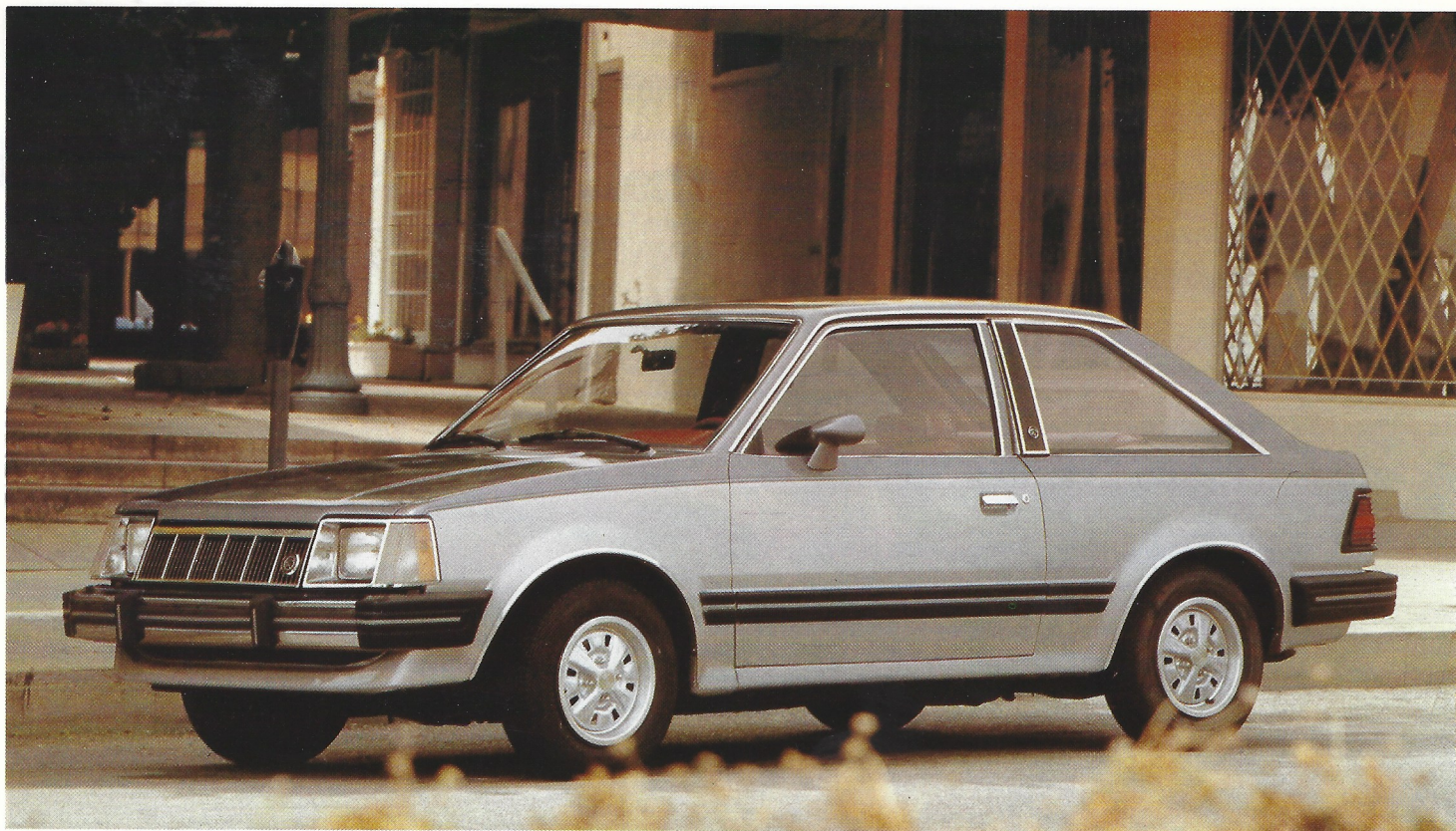
マーキュリー・リンクス。グリルやテールランプを換えて、エスコートより僅かに高級イメージを出しているマーキュリー版。短く残したテールとビルトインされたスポイラーがエリカ・ボディの大きな特徴。
