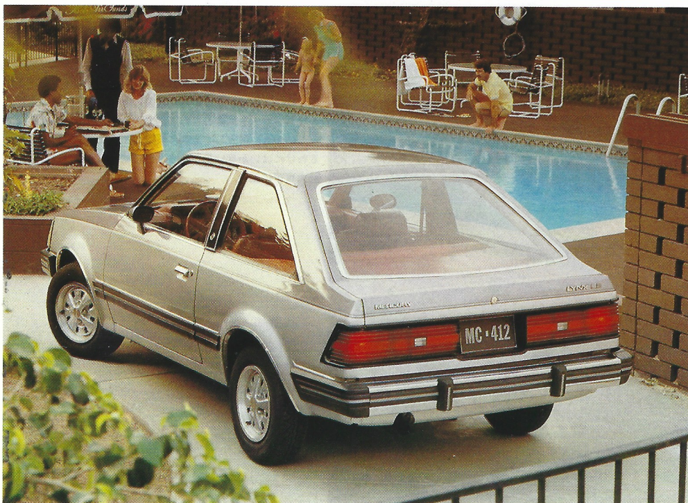
マーキュリー・リンクス。グリルやテールランプを換えて、エスコートより僅かに高級イメージを出しているマーキュリー版。短く残したテールとビルトインされたスポイラーがエリカ・ボディの大きな特徴。
