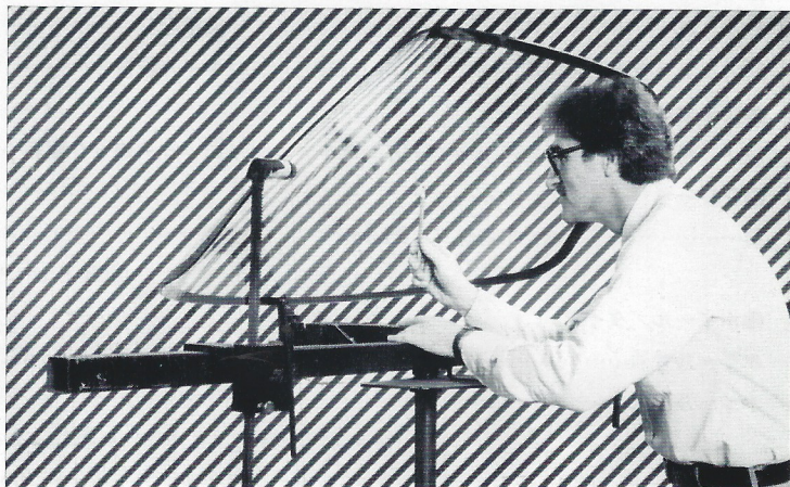
フォード社ガラス部門技術センターのエンジニアによりゼブラボードの前で透過像の歪曲度をチェック中のマスタングGTP用ウィンドシールド。素材は自社開発の薄肉合わせガラス、Cd低下のため強い曲面に成形してある。
