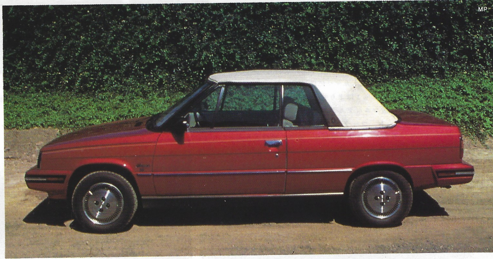
AMC・アライアンス・コンバーティブル。フランスのルノー公団と提携し、ルノー9と11を生産することで、83年の業績を大きく伸ばしたAMCは、アライアンス(ルノー9)にコンバーティブル仕様を加えた。エンジンは今年からアライアンスとアンコールに加わったOHC1.7ℓ、燃料噴射、77.5HPのユニットである。
