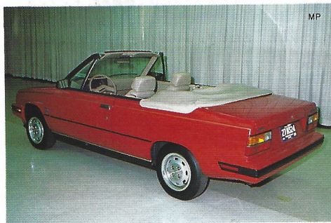
AMC・アライアンス・コンバーティブル。フランスのルノー公団と提携し、ルノー9と11を生産することで、83年の業績を大きく伸ばしたAMCは、アライアンス(ルノー9)にコンバーティブル仕様を加えた。エンジンは今年からアライアンスとアンコールに加わったOHC1.7ℓ、燃料噴射、77.5HPのユニットである。
