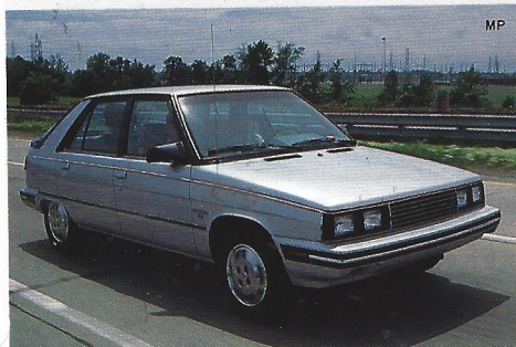
左：AMC・アンコール。アンコール(ルノー11)には、標準の1.4ℓ55HPに加え、1.7ℓ77.5HPユニットも供給されることになった。このエンジンの登場によりアンコールのスポーティー・バージョンであるGSは、北米市場においてVWラビットGTL、クライスラー(三菱)コルト・ターボなどがひしめくコンパクト・スポーティーカーの市場で強力なコンテンドーとなった。
