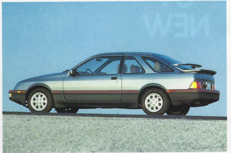
フォード・マーカー・XR7i。フォードはリンカーン／マーキュリーのディーラーを通じ、ドイツ・フォードのシエラをマーカー (Mercur) の名で販売する。85年型ではエンジンをヨーロッパ仕様の2.8ℓ V 6にかえ、2.3ℓの4気筒にターボチャージャーを装着、170HPにチューンして搭載し、5段マニュアルにより、0-60mphを8秒でカバーする。フォードはこれに続き新グラナダをベースとしたセダンと、フェイスリフトしたシエラ・ステーション・ワゴンも輸入する計画である。
