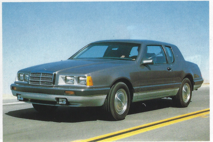
フォード・サンダーバード・ターボ・クーペ。(左) マーキュリー・クーガー・XR7・ターボ。(右) サンダーバードとクーガーのターボモデルは、2.3ℓ 4気筒エンジンが従来の145HPから170HPへと大幅にパワーアップされ、ダッシュボードが、デジタルとアナログを組み合わせたデザインに一新された。クーガーはいよいよメルセデスに似てきた感じだ。
