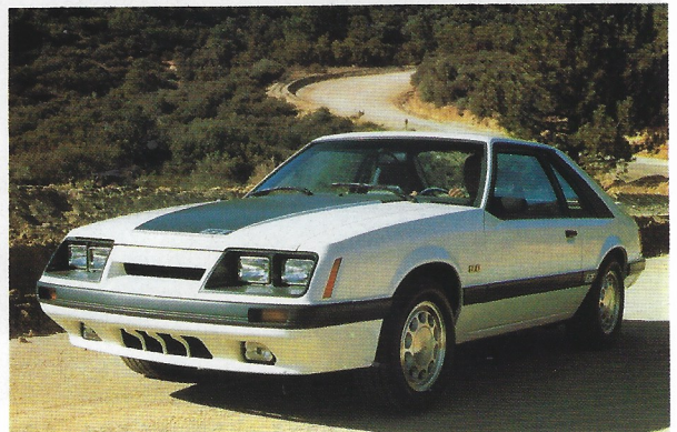
右下：フォード・マスタング・GT。5.0ℓ V 8 を搭載するマスタングとそのマーキュリー版カプリRSは210HPに、2.3ℓターボのマスタングSVOには、85年 \frac{1}{2} モデルからインタークーラーが装着され205HPになる。
