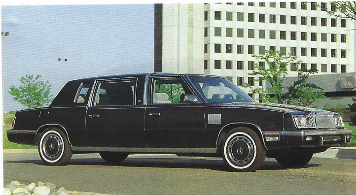
クライスラー・エクスクルーシヴ・リムジン。85年モデルから、キャデラックのリムジンがFWD化されたが、クライスラーはそれより一足先にKカーをベースにしたリムジンを生産している。ホイールベースはKカーの2540mmを3325mmに延長、全長は5345mmである、またWB3150mm、全長5165mmのエクスクルーシヴ・セダンも存在する。ともにルバロンの名を冠する。
