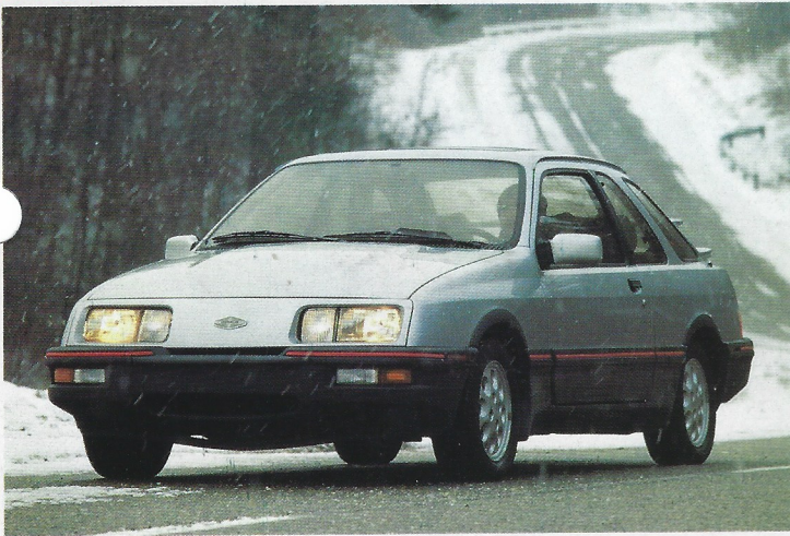
フォード・マーカー・XR7i。フォードはリンカーン／マーキュリーのディーラーを通じ、ドイツ・フォードのシエラをマーカー (Mercur) の名で販売する。85年型ではエンジンをヨーロッパ仕様の2.8ℓ V 6にかえ、2.3ℓの4気筒にターボチャージャーを装着、170HPにチューンして搭載し、5段マニュアルにより、0-60mphを8秒でカバーする。フォードはこれに続き新グラナダをベースとしたセダンと、フェイスリフトしたシエラ・ステーション・ワゴンも輸入する計画である。
